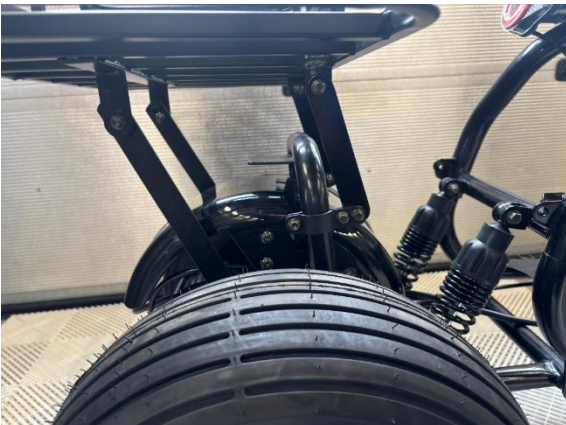
Aseta takakori paikalleen. Säädä asento suoraan.
