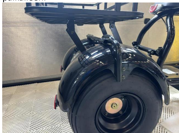
Kiinnitä ja kiristä takakorin ylemmät kiinnityspultit loppuun. (hylsy 10 mm). Tarkasta, että takalokasuojat on asennettu oikein, niin että takalokasuojien etu- ja takapuolella on sama rako.
