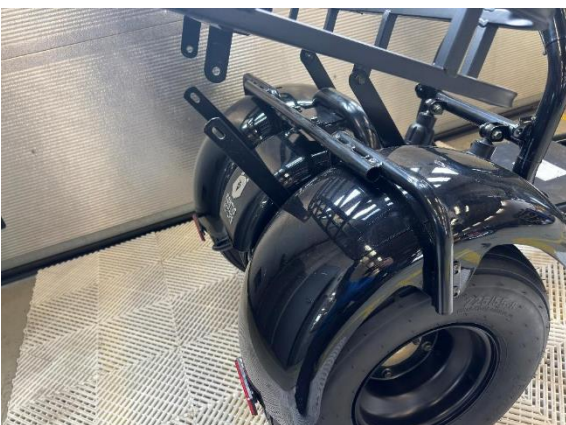
Ota takakorin ylemmät takakiinnityspultit pois. Taita takakori eteen, jolloin saa asetettua ja kiinnitettyä takalokasuojat takaisin paikalleen.
