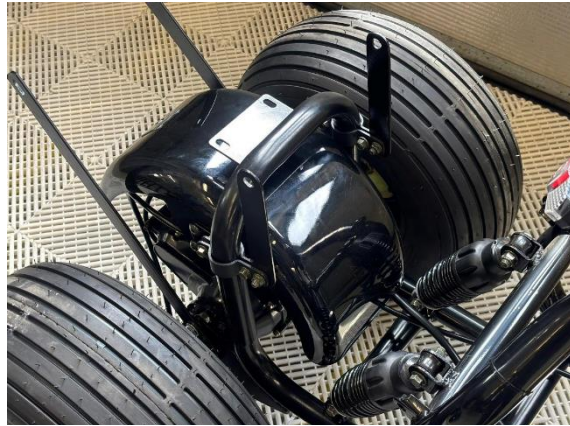
Aseta etummaisets kiinnikeraudat kiinnikkeiden väliin.
